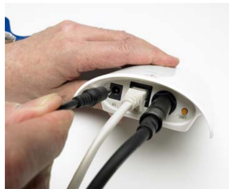
Verbinden Sie das optionale Netzteil mit dem Anschluss X1
