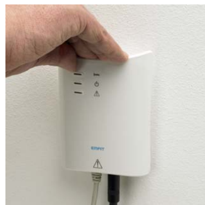
Führen Sie das Steuergerät von oben abwärts in die Halterung, bis Sie ein leichtes Klicken vernehmen.
