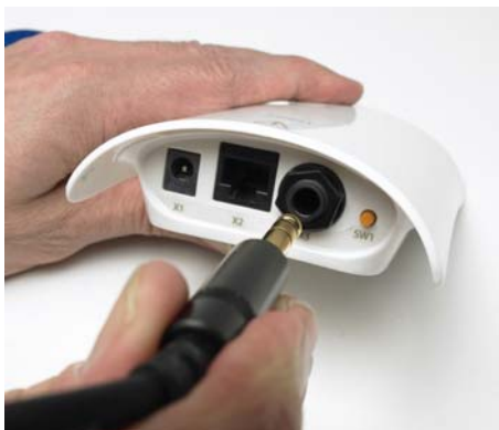
Verbinden Sie den Sensorstecker mit dem Anschluss X3.
